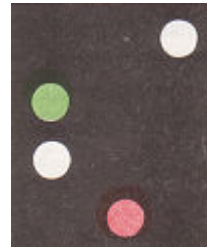
Treiler langer of korter dan 50m, vaartlopend, aan bakboord gezien
