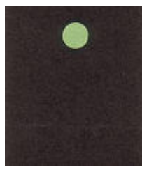
Zeilvaartuig korter dan 20m met driekleurige lantaarn, varende, aan stuurboord gezien
