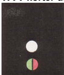
WVV korter dan 20m, varend, rechttop gezien, met samengestelde lantaarn
