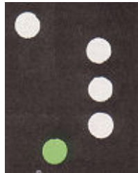
WVV slepend, langer of korter dan 50m, sleeplengte groter dan 200m, aan stuurboord gezien
