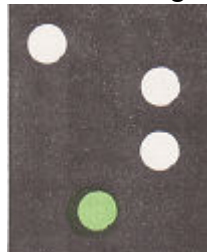
WVV slepend, duwend of langsij slepend langer of korter dan 50m, sleeplengte tot 200m inbegrepen, aan stuurboord gezien
