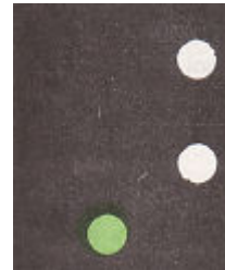
WVV slepend, duwend of langsij slepend, korter dan 50m, sleeplengte tot 200m, aan stuurboord gezien
