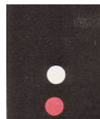
WVV korter dan 20m, varend, aan bakboord gezien, met samengestelde lantaarn
