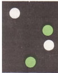
Treiler langer of korter dan 50m, vaartlopend, aan stuurboord gezien
