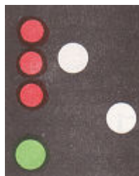
Diepstekend WVV langer of korter dan 50m, varend, aan stuurboord gezien
