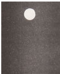
WVV korter dan 7m, max. snelheid 7kn, varend, zonder zijlichten
