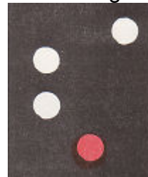
WVV slepend, duwend of langsij slepend langer of korter dan 50m, sleeplengte tot 200m inbegrepen, aan bakboord gezien
