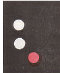
WVV slepend, duwend of langsij slepend korter dan 50m, sleeplengte tot 200m inbegrepen, aan bakboord gezien
