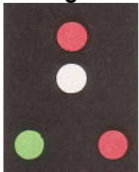
Vissersvaartuig, geen treiler, vistuig gelijk aan of korter dan 150m, vaartlopend, rechtop gezien
