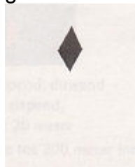
WVV slepend, langer of korter dan 50m, sleeplengte groter dan 200m, aan stuurboord gezien
