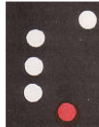
WVV slepend, langer of korter dan 50m, sleeplengte groter dan 200m, aan bakboord gezien
